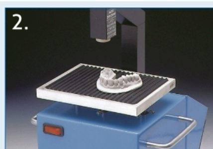
2. Zahnkranzbohrungen mit geeignetem Pinbohr-Gerät durchführen drill holes with an appropriate pinsetter
