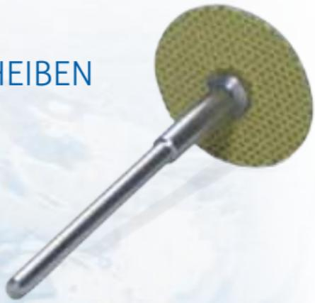
Textiles Trägermaterial mit einseitig aufgebracht Diamantfeldern auf der Scheibe (bei der Verwendung dem Mandrellschaft zugewandt aufbringen). Hochflexibel – für gute Anpassung der Scheiben an die Werkstücke.
