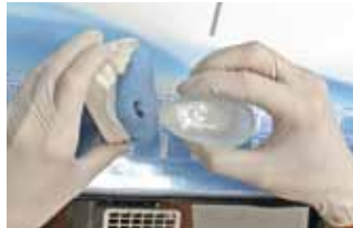
►8 und 9 Clearsplint-Kunststoff fließt im Gießverfahren in den Vorwall
